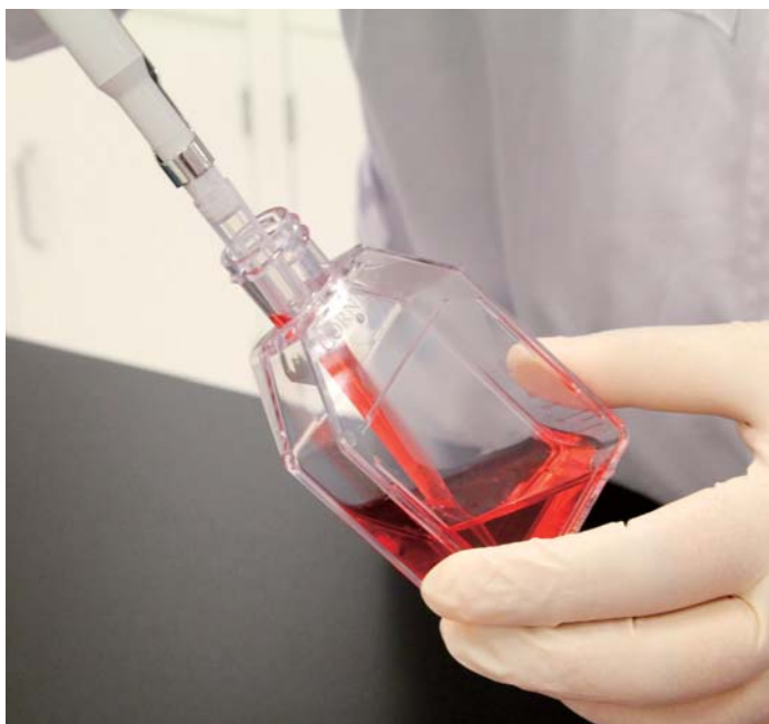
圖1. 用1mL加長微量滴管為小的細胞培養瓶（T25）直接換液，簡單方便
